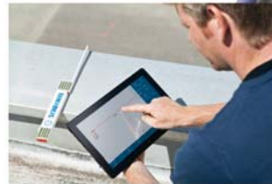
Kantprofil erstellen auf der Baustelle
